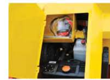
Caisse à outils incorporée avec lunettes, Clé de 46, casque... et accès rapide aux organes
