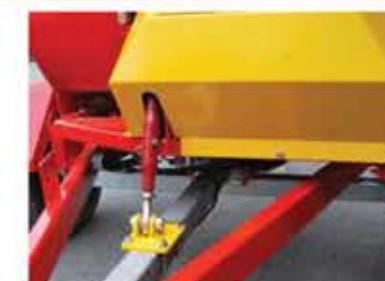
Réglage de l'inclinaison du châssis selon la hauteur d'accrochage (sur 125M)
