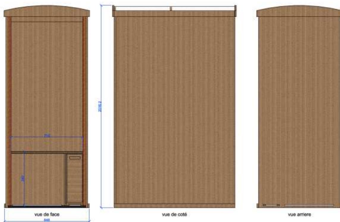
Dimensions du toilette sèche "KAGUI-BUILD"
